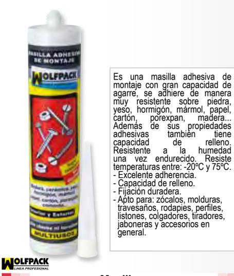
Es una masilla adhesiva de montaje con gran capacidad de agarre, se adhiere de manera muy resistente sobre piedra, yeso, hormigón, mármol, papel, cartón, porexpan, madera... Además de sus propiedades adhesivas también tiene capacidad de relleno. Resistente a la humedad una vez endurecido. Resiste temperaturas entre: -20°C y 75°C.
